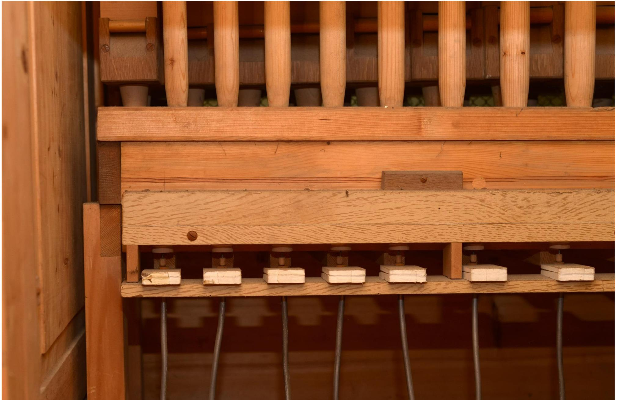
Die Steuerungsluft kommt von unten, durch die kleinen Röhrrchen und öffnet das Steuerungsventil (weiße, eckige Bauteile)
