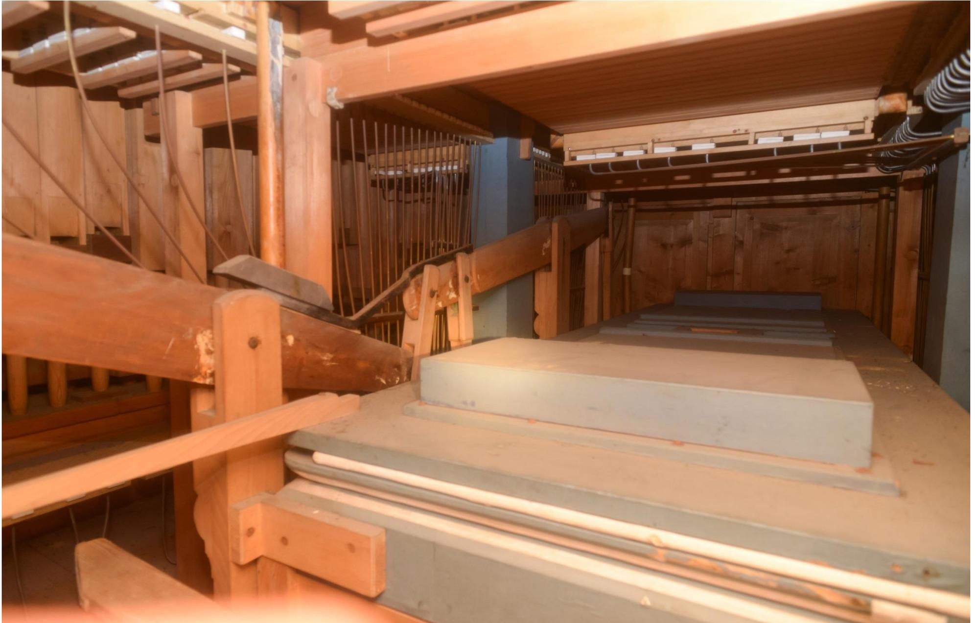
Sowohl die Steuerungsluft, als auch die Luft für die Töne wird in dem großen Blasebalg gespeichert, der über die ganze Breite geht. Hier ist er noch leer.
