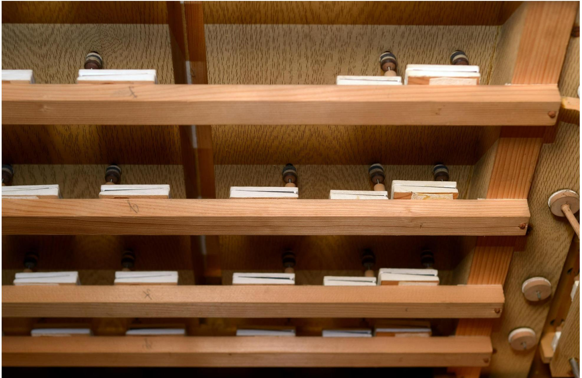
Die geöffneten Steuerungsventile schieben einen Stift nach oben, der oben den Windkanal für die große Luft zum Orgelpfeife anblasen öffnet. Die Lederdichtungen dafür sind ein Problem und werden brüchig und schimmelig und müssen regelmäßig (ca. alle 50 Jahre) ausgewechselt werden
